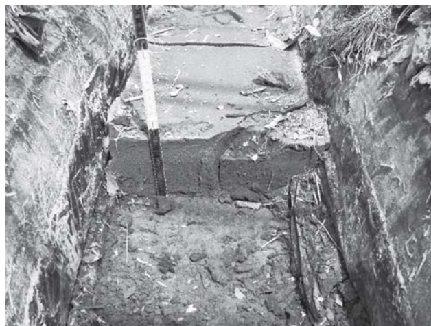
写真4 イチゴハウスの畝間に堆積した津波土砂
