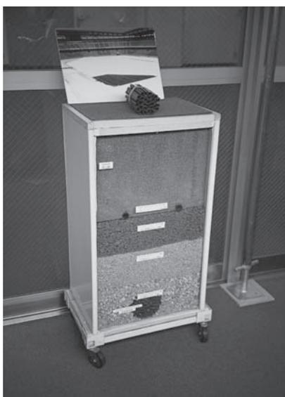
写真3 横浜国際総合競技場床土構造断面構造の模型
